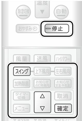
**1** 停止中に **スイング** を約 5 秒間長押しし、据え付け位置の設定画面を表示する
