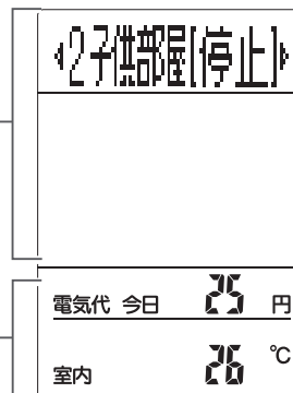
《子供部屋のエアコン操作画面》
