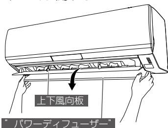
※ 無理に強い力を加えると、上下風向板・"パワーディフューザー"が破損したり内部の部品が故障したりするおそれがあります。
