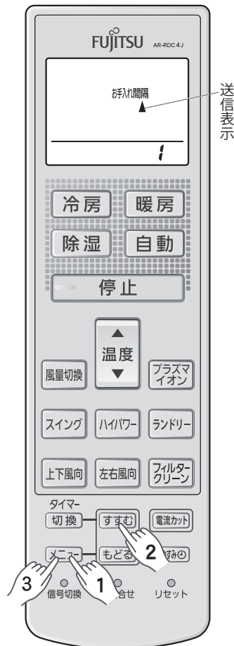
(例) フィルタークリーン動作間隔を「1 (短め)」に設定した場合
