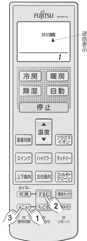
(例) フィルタークリーン動作間隔を「1 (短め)」に設定したとき
