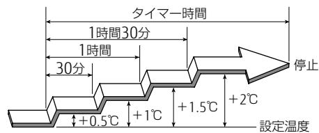
おやすみタイマーを設定すると、30分ごとに設定温度が $1^{\circ}\text{C}$ ずつ下がります。合計 $4^{\circ}\text{C}$ 下がった時点で、その温度を保ち、設定した時間後に自動的に運転を停止します。
