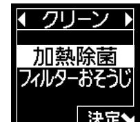
本体のクリーンランプ(黄)が点灯し、加熱除菌が始まります。
