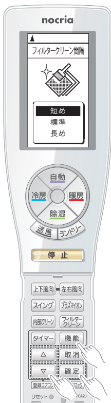
(例) フィルタークリーン動作間隔を「短め」に設定する場合
